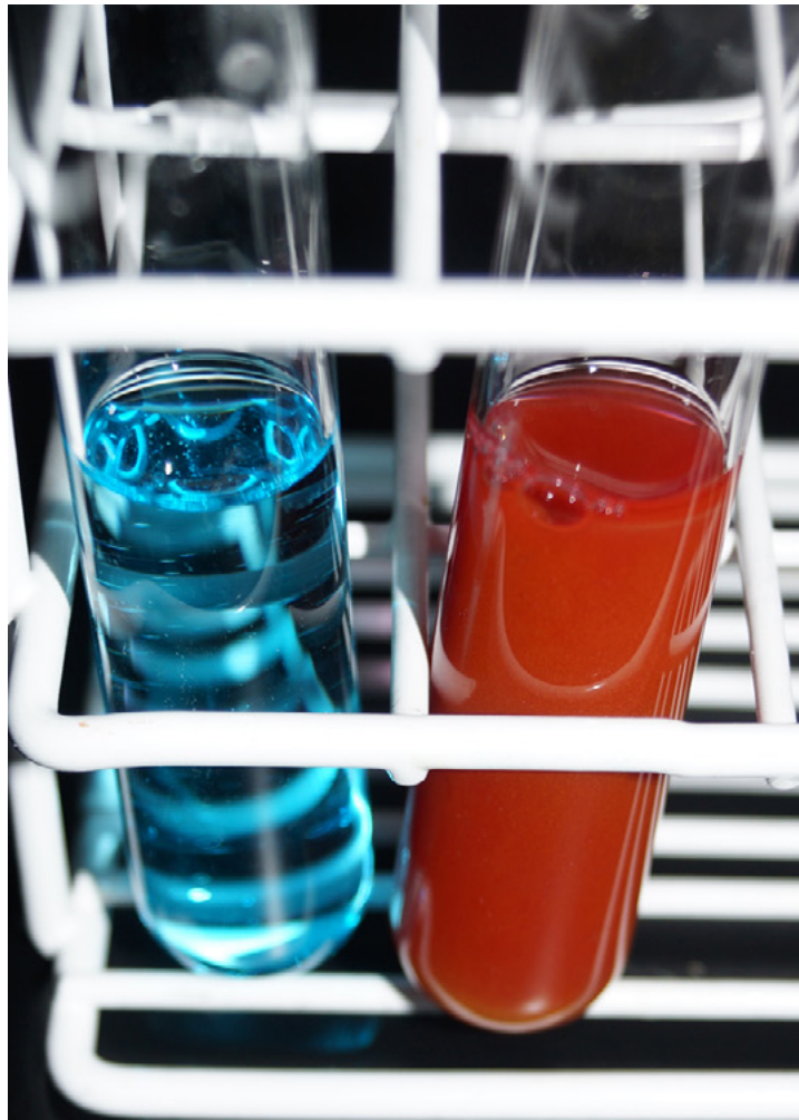
Figur 13.10 Påvisning af monosakkarider med Benedicts reagens. Til venstre lige efter tilsætning af reagensen og til højre efter 2 minutter s kogning. Den røde farve påviser tilstedeværelsen af monosakkarider. FOTO: A. Hyldal - yubio.
